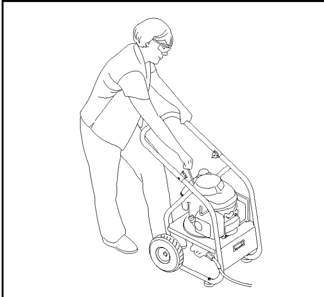
Figura 38 - Posición Recomendada para Poner en Marcha el Motor
