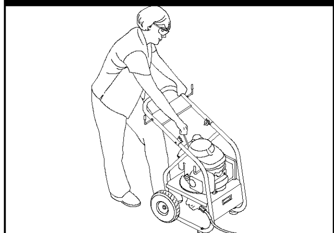
Figura 36 - Posición Recomendada para Poner en Marcha el Motor
