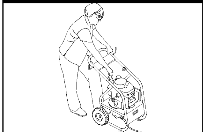
Figura 36 - Posición Recomendada para Poner en Marcha el Motor
