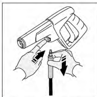
6. Retirez le tuyau à haute pression du pistolet de pulvérisation.
