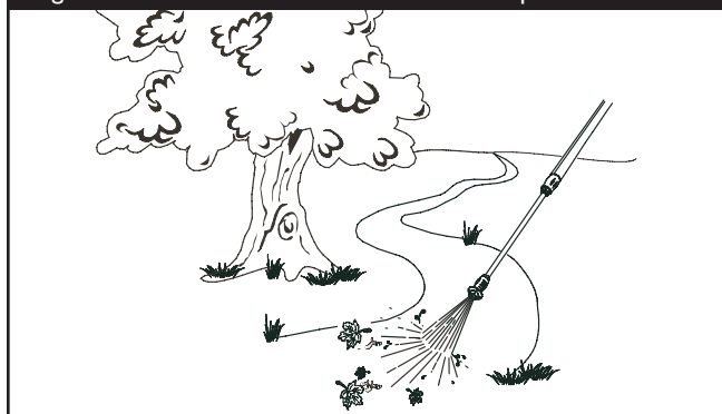
Figura 25 — Poner a Prueba el Patrón de Aspersión
