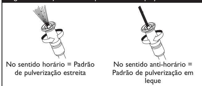
Figura 56 — Ajuste do Bico para Forma de Spray
