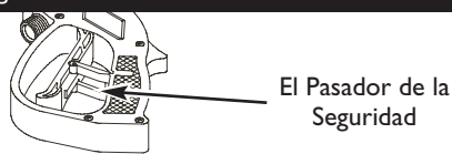
Figura 30 — La Pistola Rociadora con el Pasador de Seguridad en su Posición
