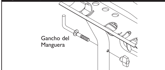
Figura 27 - Fijar el "L" Perno a la Manubrio
