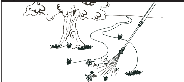
Figure 33 — Test de la forme du jet
