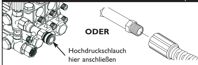
Abb. 48 - Anschließen des Hochdruckschlauchs an der Pumpe
