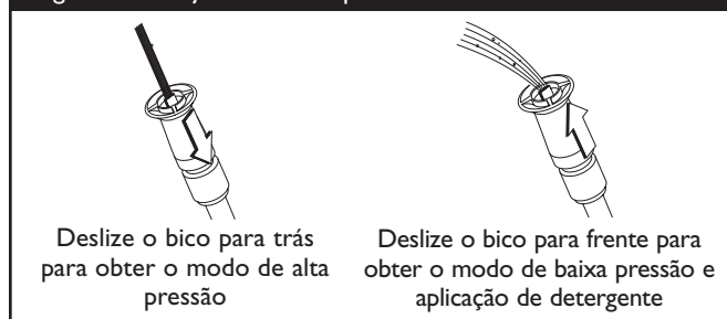
Figura 72 — Ajuste do Bico para Pressão
