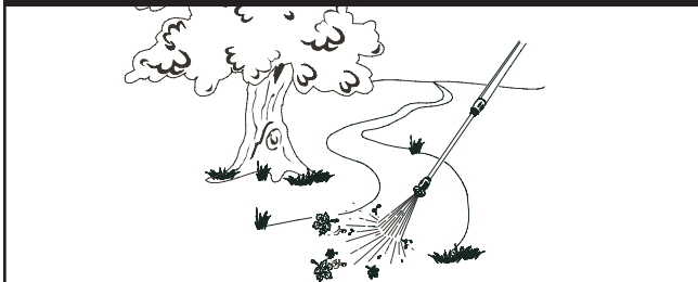
Abb. 53 - Überprüfen des Spritzmusters
