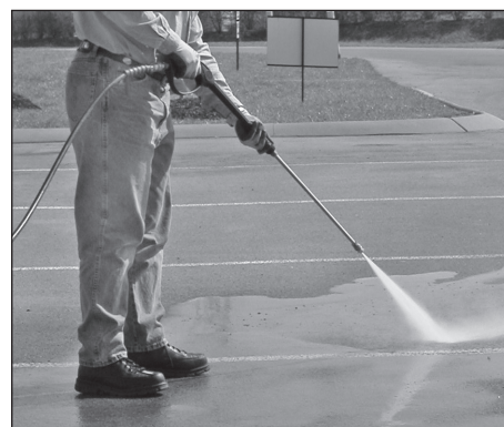
Figure 13 - Angle optimum par rapport à la surface à nettoyer
