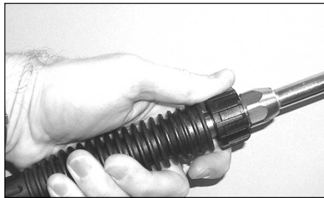
Figura 9 - Conecte la lanza a la pistola
