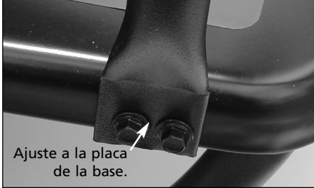
Figura 4 - Adjunte el tubo protector delantero (si se aplica)
