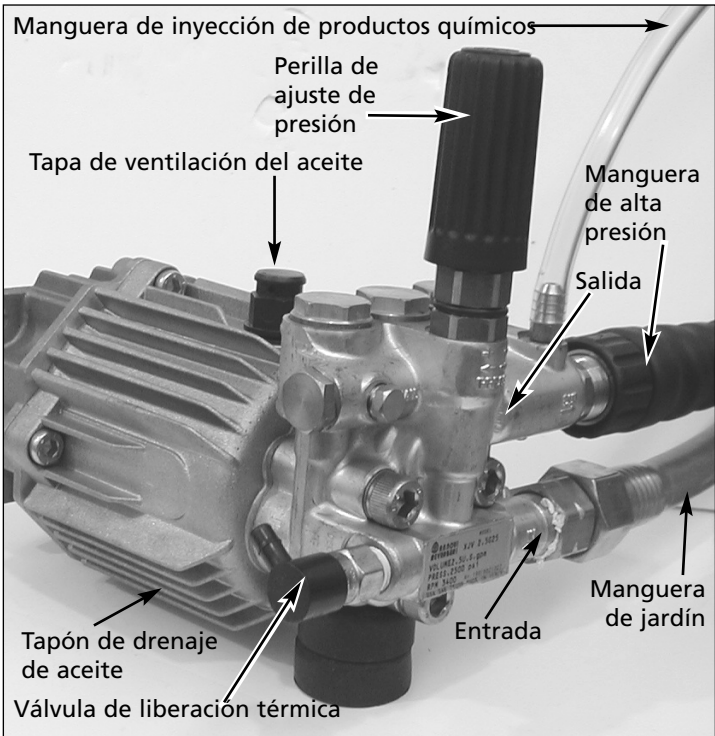
Figura 8 - Conexión de la bomba axial
