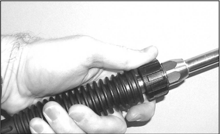
Figure 9 - Fixez le jet au pistolet
