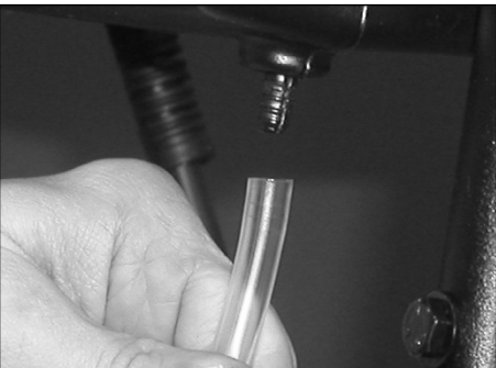
Figura 3 - Conecte el tubo de succión al conector dentado
