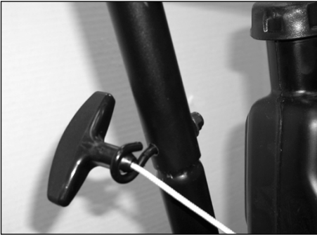
Figura 2 - Asegure el cordón de encendido del motor
