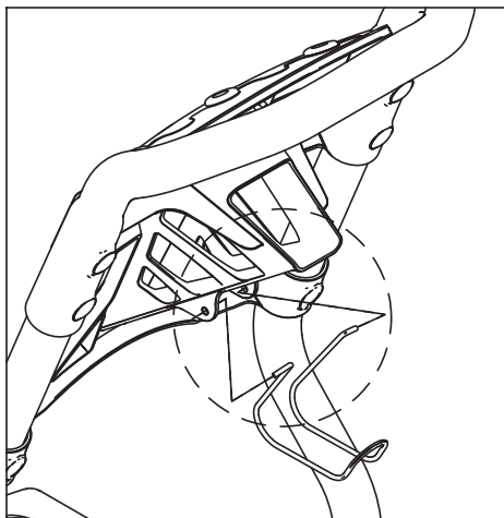
Figura 3 – Instalar el gancho para la manguera
