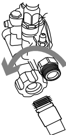
Figura 2-9. Conexión de la manguera de suministro de agua
