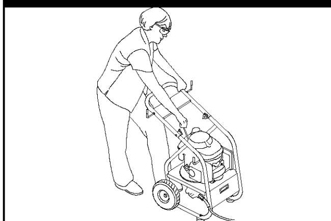
Figura 36 - Posición Recomendada para Poner en Marcha el Motor
