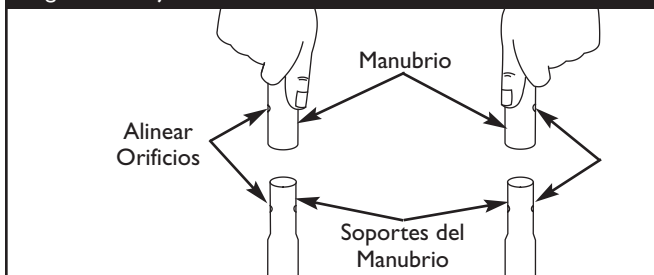
Figura 24 - Fijar el Manubrio a la Base
