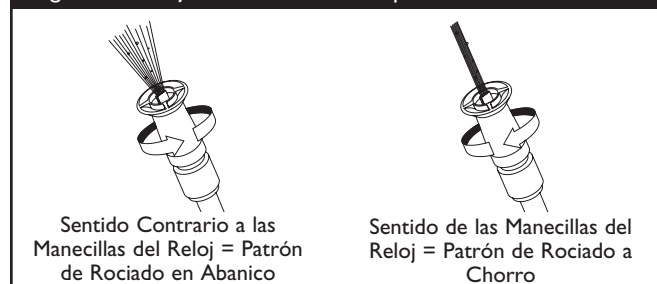
Figura 28 — Ajustar el Patrón de Aspersión
