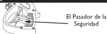
Figura 29 — La Pistola Rociadora con el Pasador de Seguridad en su Posición
