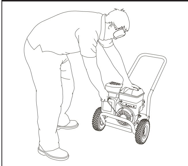
Figura 28 - Posición Recomendada para el Arranque
