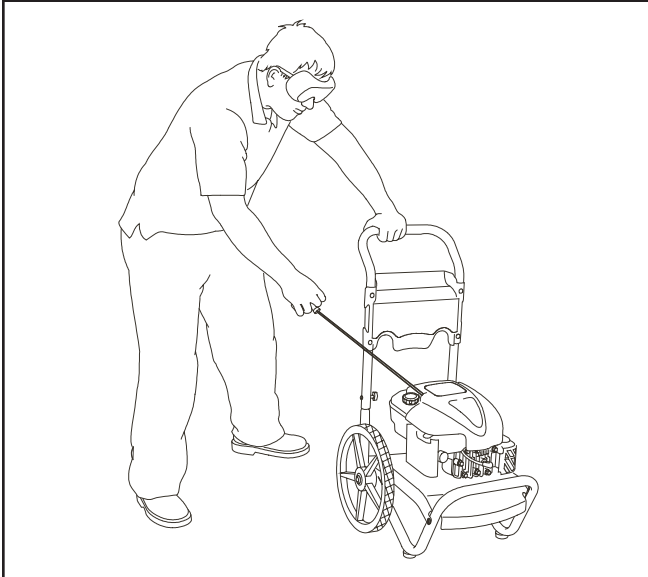
Figura 36 - Posición Recomendada para el Arranque
