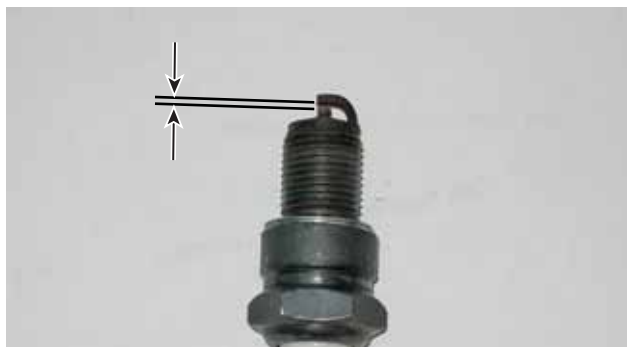
Figura 35 – Requisitos de separación de la bujía
