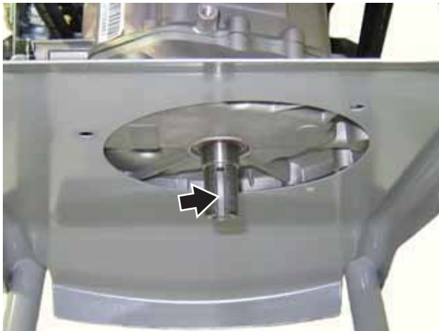
Figura 41 – Claveta y chavetero de cigüeñal
