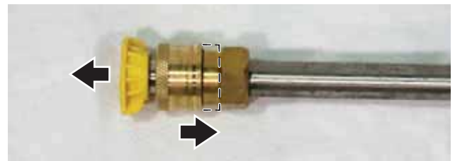
Figura 25 – Instalación de boquilla
