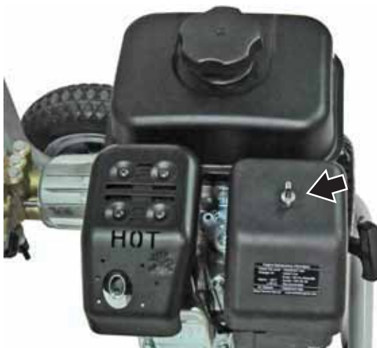
Figura 44 – Abriendo la cubierta del filtro de aire
