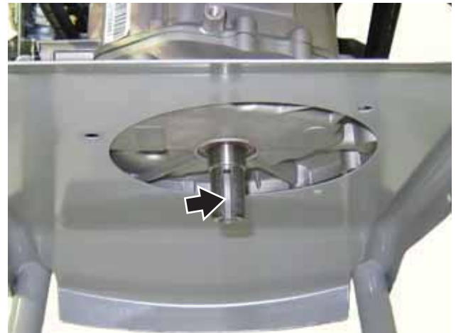
Figura 55 – Chaveta y chavetero de cigüeñal
