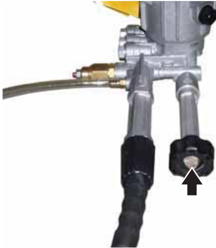
Figura 50 – Cedazo del filtro de agua (se muestra el Modelo WP2700)
