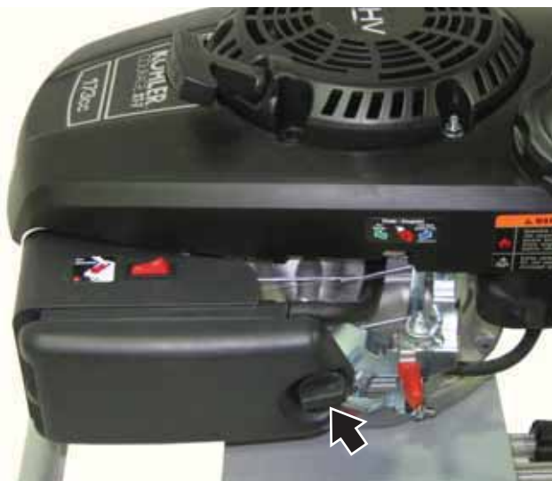
Figura 42 – Abriendo la cubierta del filtro de aire
