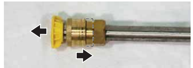
Figura 34 – Instalación de boquilla
