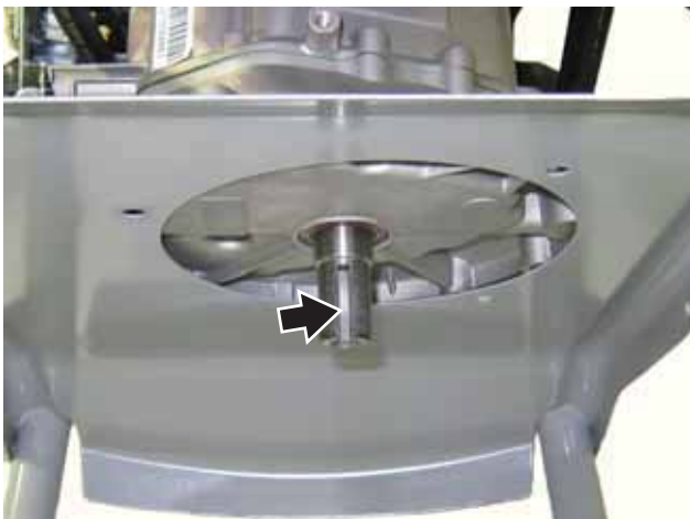
Figura 57 – Chaveta y chavetero de cigüeñal
